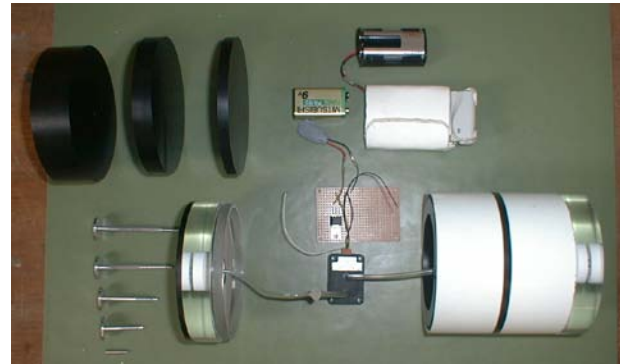
図 6 圧力伝送システムと模型 (直径 110mm 円柱) (Figure 6 A pressure telemeter system and a model (a 110mm diameter cylinder model))
