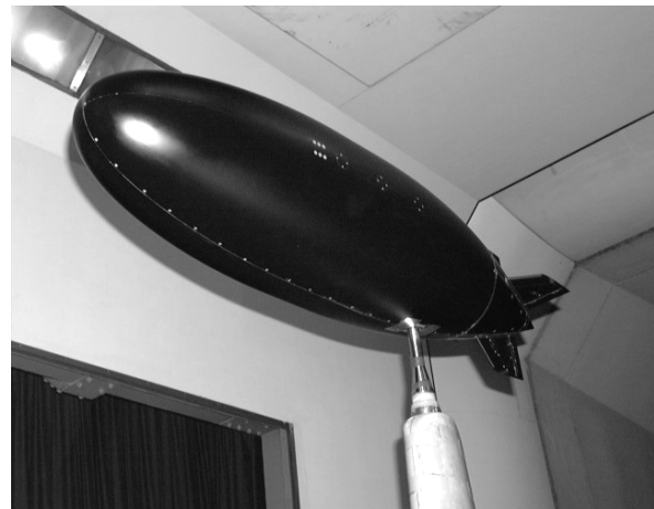
図1. 支柱によって大型低速風洞測定部に支持された飛行船模型
