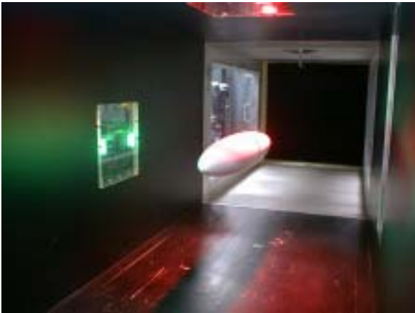
図1 60cm 磁力支持天秤装置と 6:1 回転楕円体模型 (Fig.1 6:1 ellipsoid model and the 60cm MSBS)
